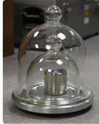
شکل ۱-۱ استاندارد ملی کیلوگرم که نسخه دقیقی از استاندارد بین‌المللی سیور فرانسه است. این نمونه، در مرکز اندازه‌شناسی در سازمان ملی استاندارد ایران نگهداری می‌شود.
